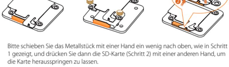
Bitte schieben Sie das Metallstück mit einer Hand ein wenig nach oben, wie in Schritt 1 gezeigt, und drücken Sie dann die SD-Karte (Schritt 2) mit einer anderen Hand, um die Karte herauspringen zu lassen.
